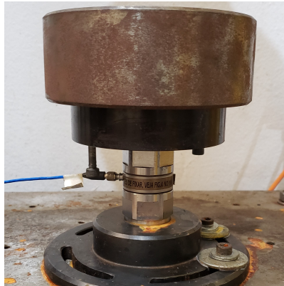
(b) Célula de carga montada.
