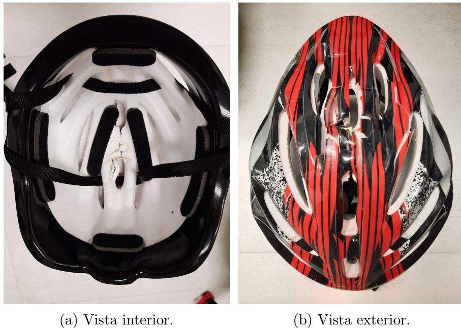
Figura 44: Capacete 5 após o impacto com a superfície plana.
